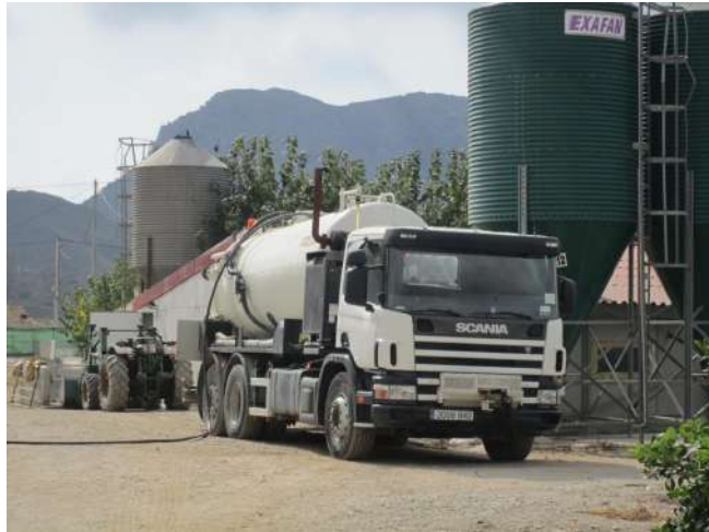
Foto de camión de limpieza de fosos
